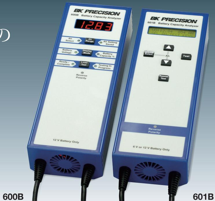
600B型、601B型 バッテリアナライザはバックアップ電源、UPS、非常用照明、火災報知機、防犯システム等様々な場所で使用されているシール型鉛蓄電池の保守、管理に伴う要求に応えます。バッテリーの負荷抵抗への反応を素早く特性評価することで、バッテリーの残存容量を健全性として表示します。
